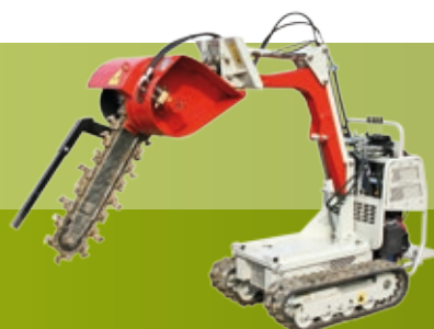
PIŁA DO WYKOPÓW TRENCHER
