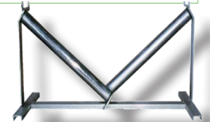
Verzinkte Kabelverlegerolle in V -Form zur Kabelführung. Verstärkte Version für Schwerst-Kabel. Rollen auf abgedichteten Kugellagern
