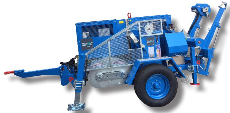
**Hydraulische Freileitungs-Winde zum Ziehen eines Seiles während des Einzugs von Freileitungen. Ein Hydraulikkreis ermöglicht die kontinuierliche Geschwindigkeitsänderung in beide Drehrichtungen. Die Winde wird über ein Bedienfeld gesteuert.**
