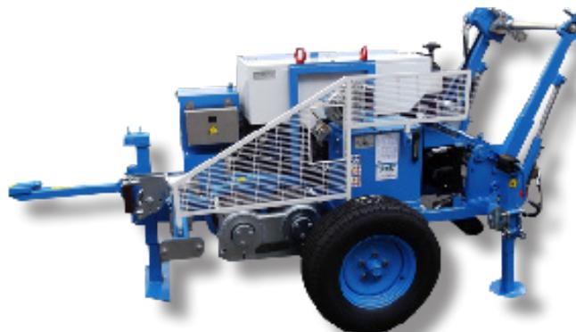
**Hydraulische Freileitungs-Winde zum Ziehen eines Seiles während des Einzugs von Freilichtwellenleitern. Ein Hydraulikkreis ermöglicht die kontinuierliche Geschwindigkeitsregulierung in beide Drehrichtungen, gesteuert wird die Winde über ein Bedienfeld.**
