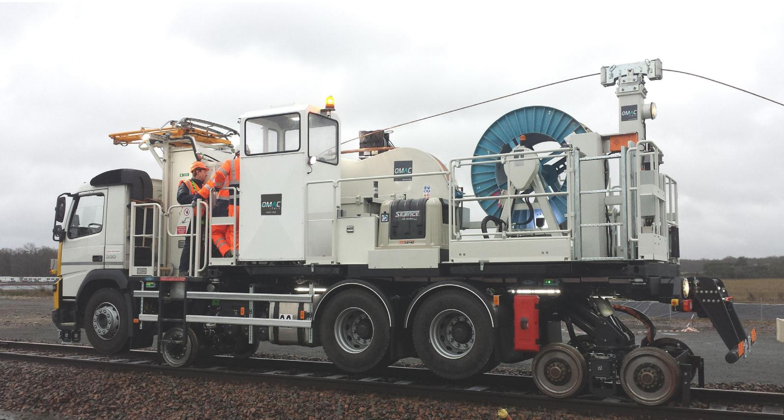
**“OBERLEITUNGSMONTAGE-EINHEIT auf ZWEIWEGEFAHRZEUG“ Für 1 Leitung, 1 TROMMELBOCK**
