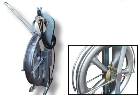
**F145...E** Montageblock mit drei Rollen zum Einzug eines vorläufigen Seiles aus dem Hubschrauber. Geeignete Vorrichtungen ermöglichen die Platzierung eines Seiles in der Rollenrinne und verhindern das Herausrutschen.
