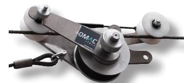
**F405.15.RR Schutzvorrichtung für Roboter im Falle von besonderen Bedingungen und einer extremen Neigung.**
