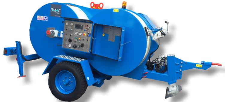
**Hydraulische Bremse zum Spannen einer Leitung oder von zwei Leitungen, oder Freilichtwellenleitern. Ein Hydraulikkreis ermöglicht die Spannung mit konstanter Kraft auch bei Geschwindigkeitsänderung. Die Maschinenverwendung als Winde, zur Leitungsrückgewinnung ist ebenfalls möglich.**
