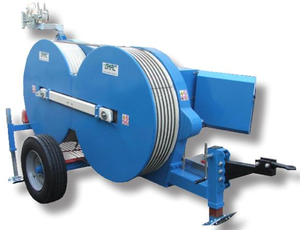
**Hydraulische Bremse zum Spannen von 1 - 2 Leitungseilen oder Freilichtwellenleitern.
