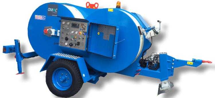
**Hydraulische Bremse zum Spannen einer Leitung oder von zwei Leitungen, oder Freilichtwellenleitern. Ein Hydraulikkreis ermöglicht das Spannen mit konstanter Kraft auch bei Geschwindigkeitsänderung. Die Maschinenverwendung als Winde, zur Leitungsrückgewinnung ist ebenfalls möglich.**
