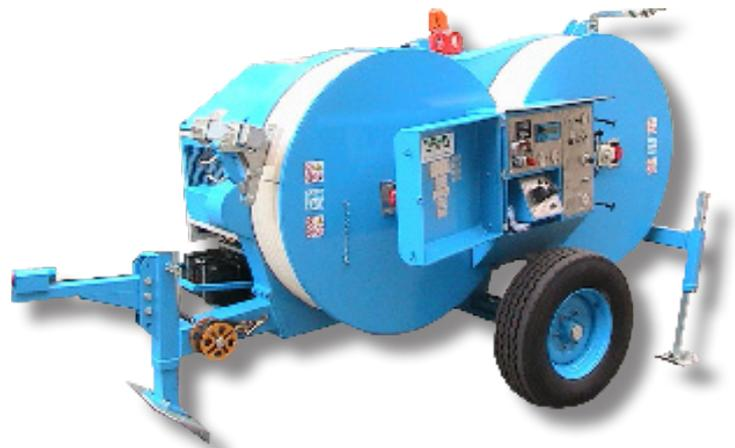
**Hydraulische Bremse zum Spannen einer Leitung oder eines Freilichtwellenleiters. Ein Hydraulikkreislauf ermöglicht das Spannen einer Leitung mit konstanter Kraft, auch bei Änderung der Zuggeschwindigkeit. Nutzung der Maschine als Winde zur Leitungsrückgewinnung möglich.**
