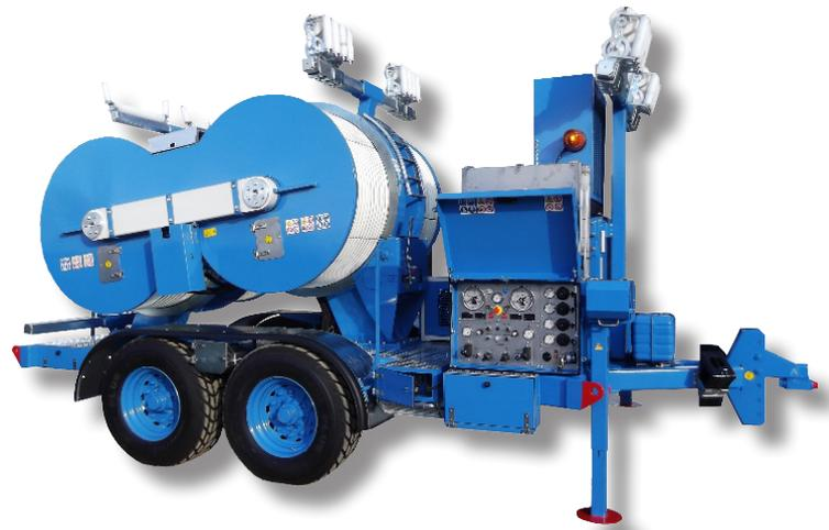
**Hydraulische Bremse um Spannen von 1er, 2er, 3er, 4er, 5er oder 6er Leitungsbündel**
