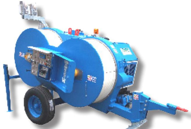
**Hydraulische Bremse geeignet zum Spannen von 1 Leiterseil oder 2 Leiterseilen, sowie zum Spannen von Freilichtwellenleitern. Ein Hydraulikkreis ermöglicht die Spannung mit konstanter Kraft, auch bei Geschwindigkeitsänderung. Ebenfalls ist eine Verwendung der Bremse als Winde zur Leitungswiederherstellung möglich.**
