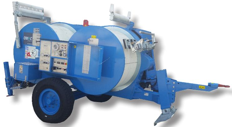
**Hydraulische Bremse zum Spannen von 1, 2, 3 oder 4 (optional bis zu 6) Leiterseilen. Ein Hydraulikkreis ermöglicht das Spannen mit konstanter Kraft auch bei Geschwindigkeitsänderung. Verwendung der Maschine als Winde zur Leitungswiederherstellung möglich.**
