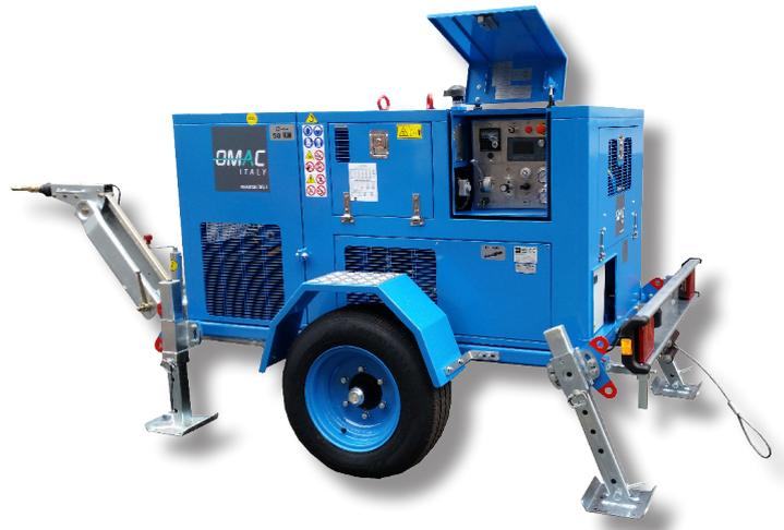
**Hydraulische Winde zum Ziehen eines Stahlseils sowie zur Verlegung von Kabelleitung und Freilichtwellenleitern. Ein Hydraulikkreis ermöglicht die kontinuierliche Geschwindigkeitsänderung in beide Drehrichtungen, gesteuert wird dies über ein Bedienfeld**
