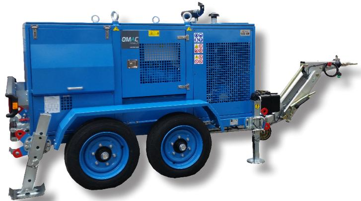
**Hydraulische Winde zum Ziehen eines Seils bei der Verlegung von Kabel- und Telekommunikationsleitungen. Ein Hydraulikkreis ermöglicht die flüssige Geschwindigkeitsänderung in beiden Drehrichtungen, gesteuert über ein Bedienfeld.**
