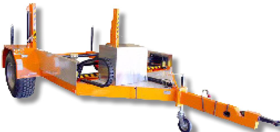
**Trommel-Anhänger für den Transport und zum Abwickeln von Kabelrollen mit einem Gewicht bis 6000 kg.**
