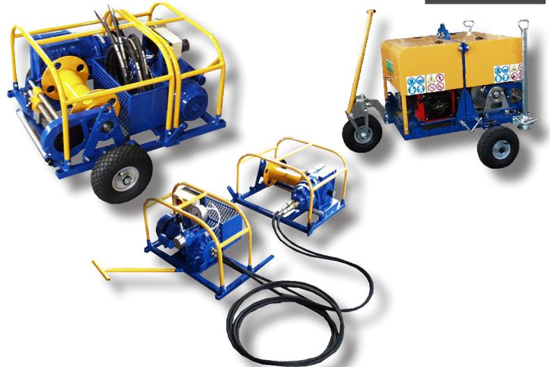
**Hydraulische Hilfsseilwinde zum Ziehen eines Seiles bei Servicearbeiten sowie bei der Verlegung von Erdkabeln. Die Winde ist leicht in zwei Teile abklappbar. Ein geschlossener Hydraulikkreis ermöglicht die ständige Geschwindigkeitsänderung in beide Drehrichtungen. Gesteuert wird diese Hilfsseilwinde über ein Bedienfeld.**
