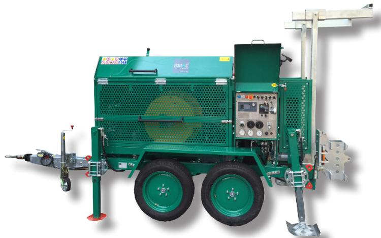
**Winde zum Kabelaufwickeln für die dauerhafte Entfernung von alten oder nicht benötigten Kabelleitungen und Fernmeldekabeln bis zu einem Durchmesser von 80 mm. Hauptsächlich zur Wiederherstellung einer Installation von Freilichtleitern. Die Winde wird durch ein Hydraulikaggregat angetrieben, welches vollständig im Gehäuseinneren eingeschlossen ist, wodurch die Lärmemission begrenzt wird. Die Maschine ist auf einem gedämpften Anhänger aufgebaut und mit Stabilisierungsstützen ausgerüstet.**
