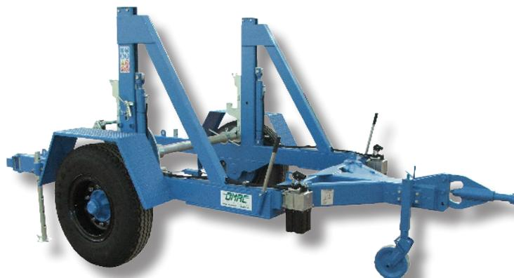
**Kabeltrommelanhänger für den Transport und zum Abwickeln von Kabelrollen mit einem Gewicht bis 8000 kg.**
