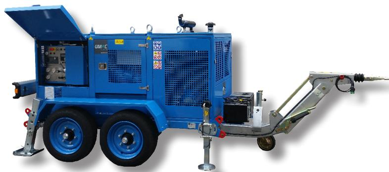
**Hydraulische Winde zum Ziehen eines Seils bei der Verlegung von Kabel- und Telekommunikationsleitungen. Ein Hydraulikkreis ermöglicht die kontinuierliche Geschwindigkeitsänderung in beide Drehrichtungen, gesteuert über ein Bedienfeld**
