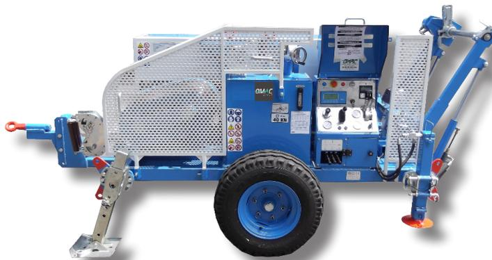
**Hydraulische Winde zum Ziehen eines Seils bei der Verlegung von Kabel- und Telekommunikationsleitungen. Ein Hydraulikkreis ermöglicht die kontinuierliche Geschwindigkeitsänderung in beide Drehrichtungen, gesteuert über das Bedienfeld.**
