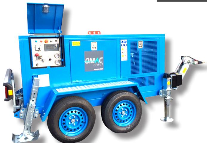
**Hydraulische Winde zum Ziehen eines Seiles bei der Verlegung von Kabel- und Telekommunikationsleitungen. Ein Hydraulikkreis ermöglicht die flüssige Geschwindigkeitsänderung in beiden Drehrichtungen, gesteuert über ein Bedienfeld.**
