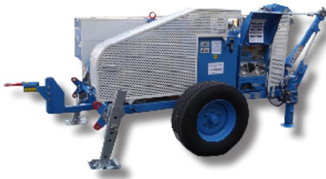
**Hydraulische Winde zum Ziehen eines Seils bei der Verlegung von Kabel- und Telekommunikationsleitungen. Ein Hydraulikkreis ermöglicht die kontinuierliche Geschwindigkeitsänderung in beide Drehrichtungen, gesteuert über ein Bedienfeld.**
