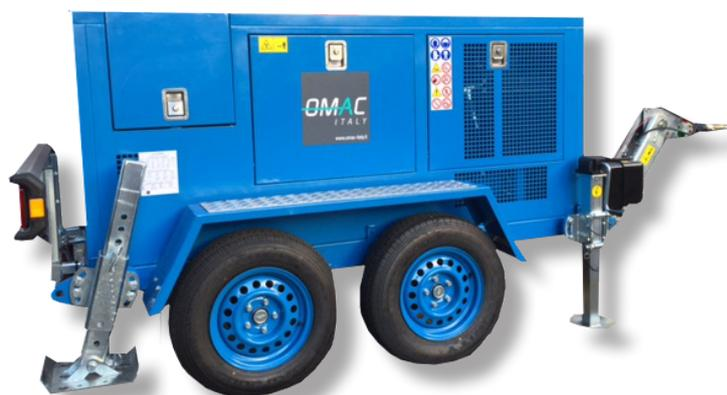
**Hydraulische Winde zum Ziehen eines Stahlseils und zur Verlegung von Kabel- und Telekommunikationsleitungen. Ein Hydraulikkreis ermöglicht die flüssige Geschwindigkeitsänderung in beiden Drehrichtungen, gesteuert über ein Bedienfeld.**
