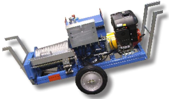
**Hydraulische Service-Winde zum Ziehen eines Seiles bei Servicearbeiten, wie Z.B. die Einstellung und Korrektur von Übertragungsleitungen, und bei Verlegung von Erdkabeln. Die Winde lässt sich leicht in 3 Teile aufklappen. Ein geschlossener Hydraulikkreis ermöglicht die kontinuierliche Geschwindigkeitsänderung in beide Richtungen, dies wird über ein Bedienfeld gesteuert.**
