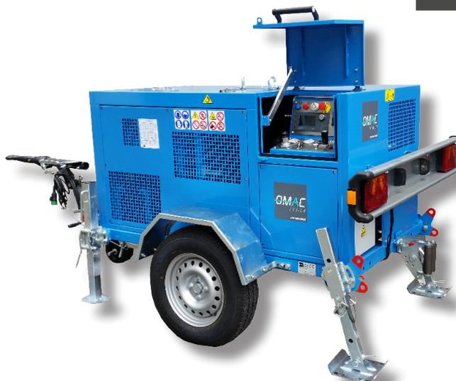
**Hydraulische Kabelziehwinde für die unterirdische Kabelverlegung, sowie für das Verlegen von Freilichtwellenleitern. Ein Hydraulikkreis ermöglicht eine kontinuierliche Geschwindigkeitsregelung in beide Drehrichtungen, gesteuert wird die Winde über ein Bedienfeld.**
