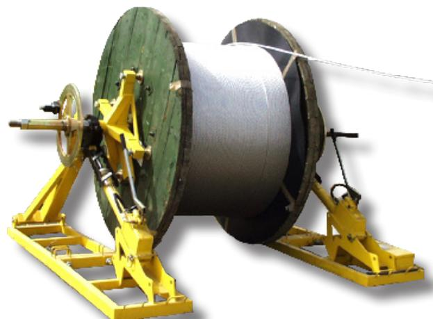
**Trommelbock für Stahl- oder Holztrommeln, zum Heben und Bremsen der Rolle während der Leitungsmontage. Optional besteht die Möglichkeit, die Trommel hydraulisch, über ein Hydraulikaggregat anzutreiben.**
