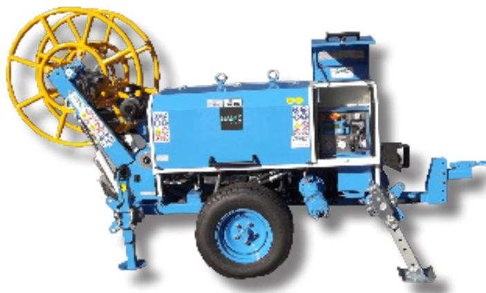
**Hydraulische Winde zum Ziehen eines Seils bei der Verlegung von Kabel- und Telekommunikationsleitungen. Ein Hydraulikkreis ermöglicht die kontinuierliche Geschwindigkeitsänderung in beide Drehrichtungen, gesteuert über ein Bedienfeld.**
