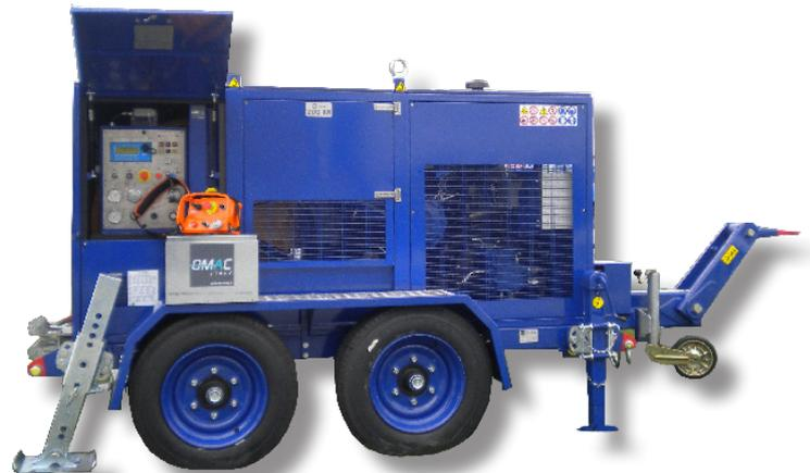
**Hydraulische Winde zum Ziehen eines Seils bei der Verlegung von Kabel- und Telekommunikationsleitungen. Ein Hydraulikkreis ermöglicht die kontinuierliche Geschwindigkeitsänderung in beiden Drehrichtungen, gesteuert über ein Bedienfeld.**
