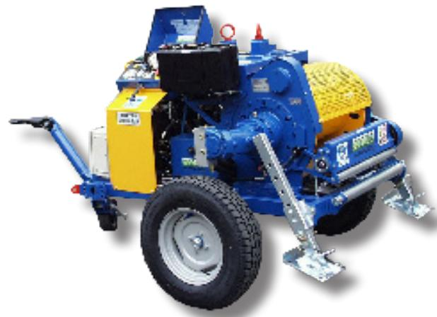
**Hydraulische Trommelwinde zum Ziehen eines Seiles bei Servicearbeiten, sowie für die Einstellung und Korrektur von Übertragungsleitungen und bei der Verlegung von Kabelleitung verwendet. Ein geschlossener Hydraulikkreis ermöglicht die ständige Geschwindigkeitsänderung in beide Richtungen gesteuert über ein Bedienfeld.**
