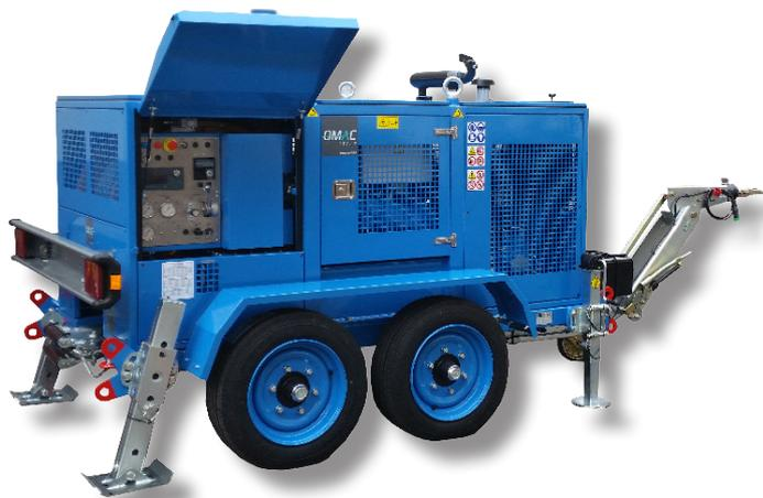
**Hydraulische Winde zum Ziehen eines Stahlseils bei der Verlegung von Kabel- und Telekommunikationsleitungen. Ein Hydraulikkreis ermöglicht die flüssige Geschwindigkeitsänderung in beide Drehrichtungen, gesteuert wird die Winde über ein Bedienfeld.**
