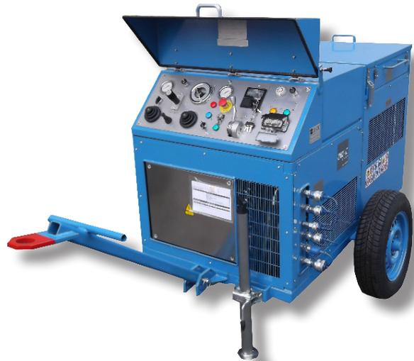
**Hydraulikaggregat mit einem Hydraulikkreis (geschlossen) geeignet für das Antreiben einer hydraulischen Winde, welche als Bremse fungieren soll, sowie für das Antreiben von Rollenständern/Trommelböcken bestimmt. Die Vorrichtung ist auch in der Lage, andere Geräte anzutreiben (siehe Option 011).**
