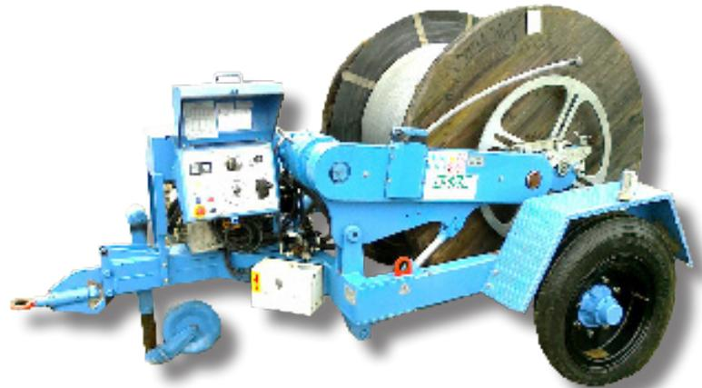
**Kabeltrommelanhänger zum Abwickeln, sowie zur Freigabe von Seilen und Leitungen auf Holz- oder Stahlkabelrollen. Die Kabeltrommel wird von einem Hydraulikmotor angetrieben und ermöglicht die Rückgewinnung von Leitung oder Kabeln (in Funktion als Winde) und zur Freigabe (in Funktion als Bremse).**
