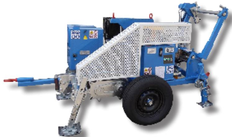
**Hydraulische Winde zum Ziehen eines Seils bei der Verlegung von Kabel- und Telekommunikationsleitungen. Ein Hydraulikkreis ermöglicht die kontinuierliche Geschwindigkeitsänderung in beide Drehrichtungen, gesteuert über ein Bedienfeld.**
