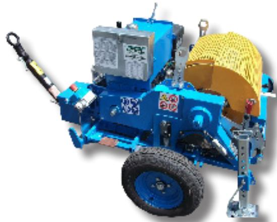
**Hydraulische Hilfsseilwinde/Mastbedienungswinde zum Ziehen eines Seiles bei Servicerarbeiten, sowie für Einstellungen und Korrekturen von Übertragungsleitungen, als auch bei der Verlegung von Erdkabeln verwendet. Ein geschlossener Hydraulikkreis ermöglicht die ständige Geschwindigkeitsänderung in beide Richtungen über ein Bedienfeld**
