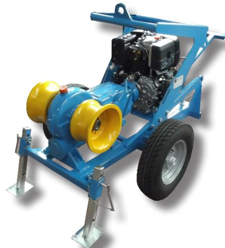
**Mechanische Hilfsseilwinde zum Ziehen eines Seiles bei der Verlegung von Erdkabeln. Die Spillkopfbewegung wird durch eine Mehrscheibenkupplung und ein Getriebe übertragen, Steuerung über 2 Bedienehebel.**
