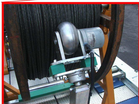
URZĄDZENIE DO SPRAWDZENIA IŁOŚCI NAWINIĘTEGO PRZEWODU NA SZPULI
