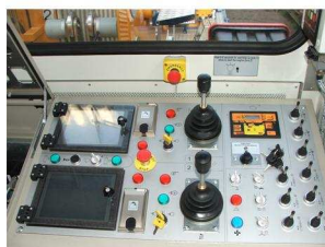
PANEL KONTROLNY DO ZARZĄDZANIA 2 OBWODAMI I 4 STOJAKAMI DO BĘBNÓW
