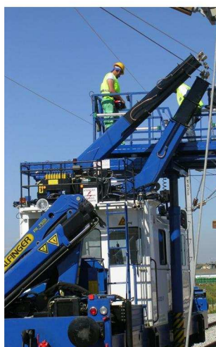
Niezależny maszt teleskopowy, wyposażony w rolki i sterowanie radiowe
