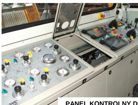
PANEL KONTROLNY DO ZARZĄDZANIA 2 OBWODAMI I 4 STOJAKAMI DO BĘBNÓW
