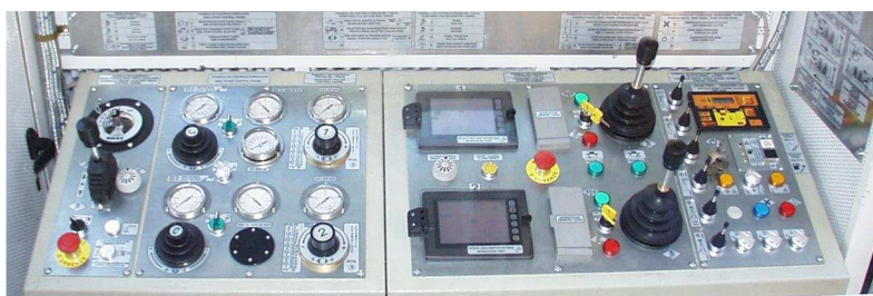
PANEL KONTROLNY DO ZARZĄDZANIA 2 OBWODAMI I 2 STOJAKAMI DO BĘBNÓW
