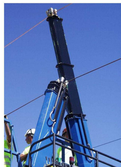
Niezależny maszt teleskopowy, wyposażony w rolki i sterowanie radiowe
