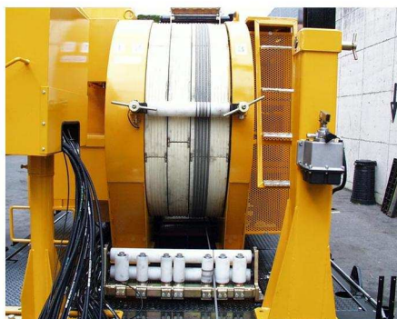
Prowadzenie przewodów do 4 przewodów
