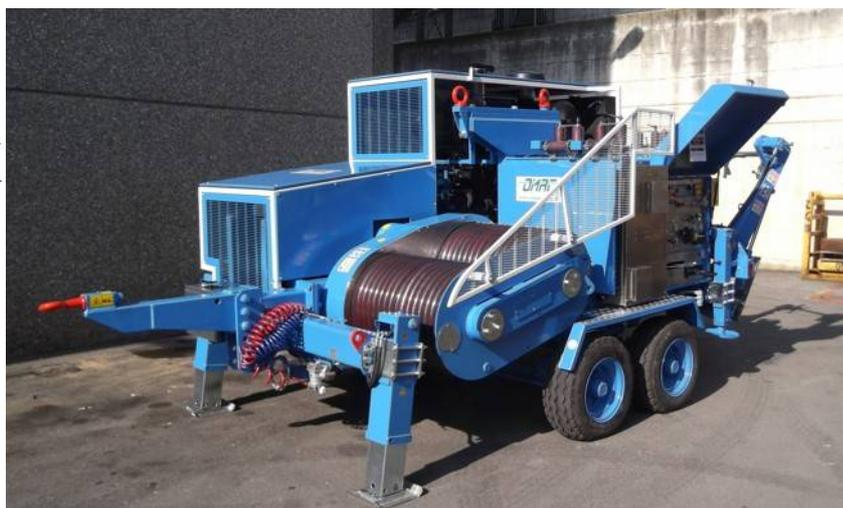
Гидравлическая натяжная машина предназначена для тяжения одного или двух тросов.
