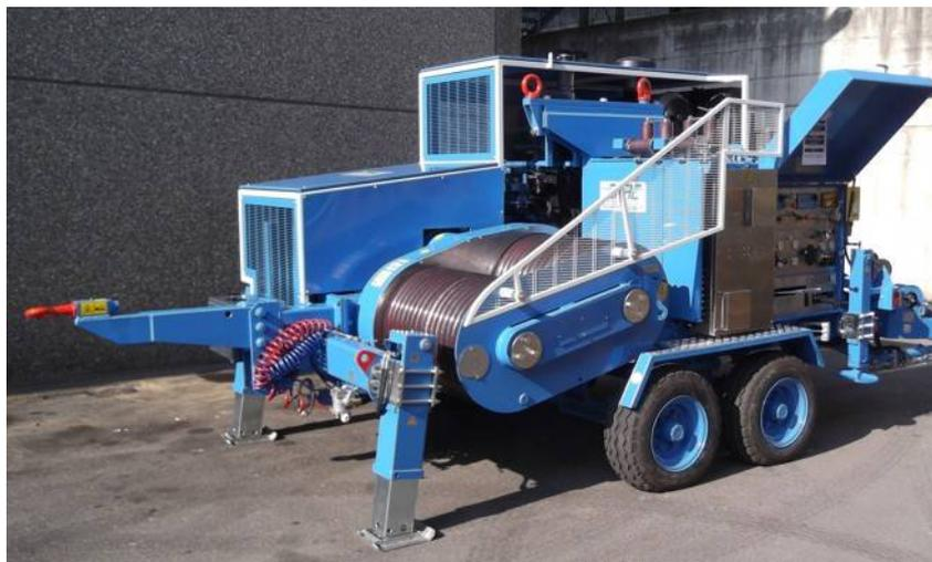
Гидравлическая натяжная машина предназначена для тяжения одного или двух тросов. Два гидравлических контура позволяют непрерывно изменять скорость в обоих направлениях работы с двумя устройствами управления. Два контура могут быть соединены и работать как один при управлении с одной панели.
