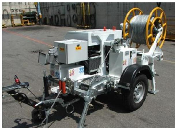
Гидравлическая натяжная машина предназначена для тязения одного троса.
