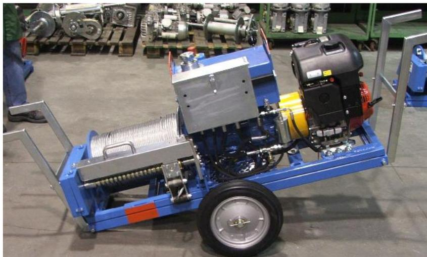
Гидравлическая лебедка предназначена для тяжения одного троса при вспомогательных операциях, а так же при монтаже и регулировках ЛЭП, и прокладках подземного кабеля. Для удобства транспортировки лебедка состоит из трех частей. Один гидравлический контур позволяет постоянно изменять скорость в обоих направлениях с помощью одной панели управления.
