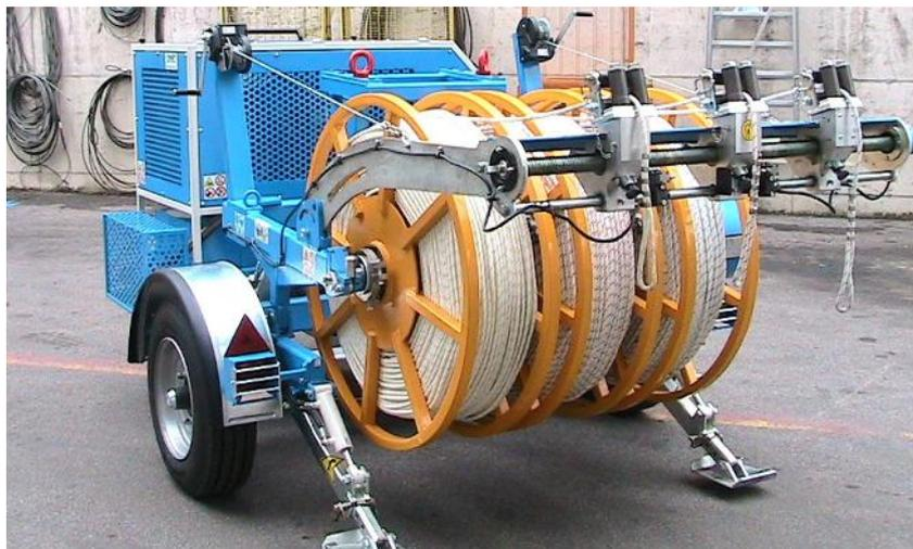
**F10.M** Трейлер для барабанов предназначен для размотки и намотки троса и провода на деревянные и стальные барабаны.
