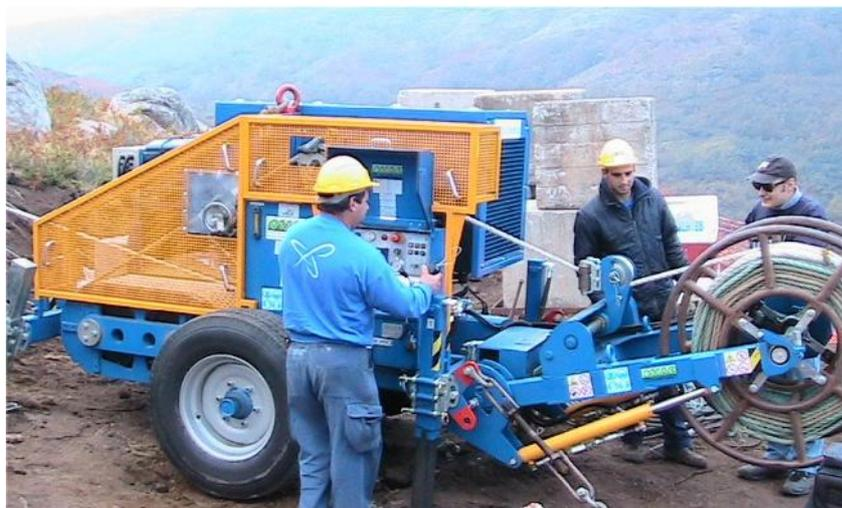
Гидравлическая натяжная машина предназначена для тяжения одного троса. Один гидравлический контур позволяет непрерывно изменять скорость в обоих направлениях работы с одним единственным устройством управления.
