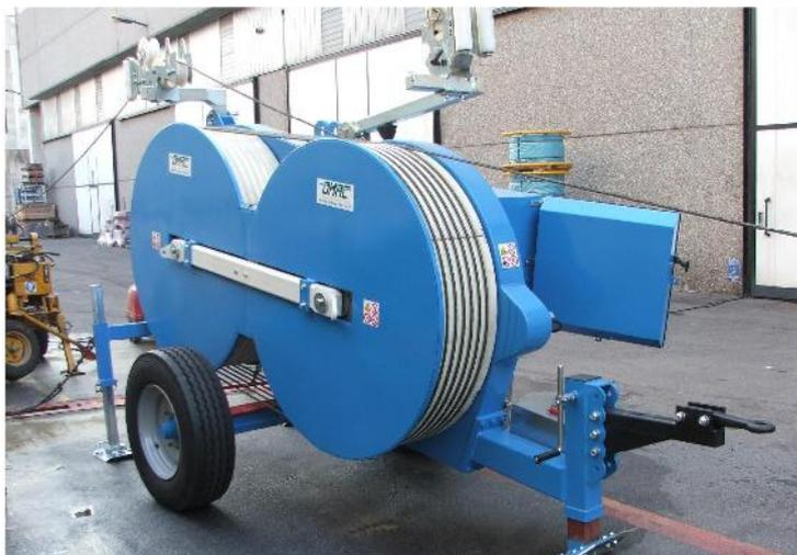
Гидравлическая тормозная машина предназначена для торможения одного провода или волоконно-оптического кабеля в процессе натяжения. Один гидравлический контур позволяет непрерывно изменять силу и скорость торможения.
