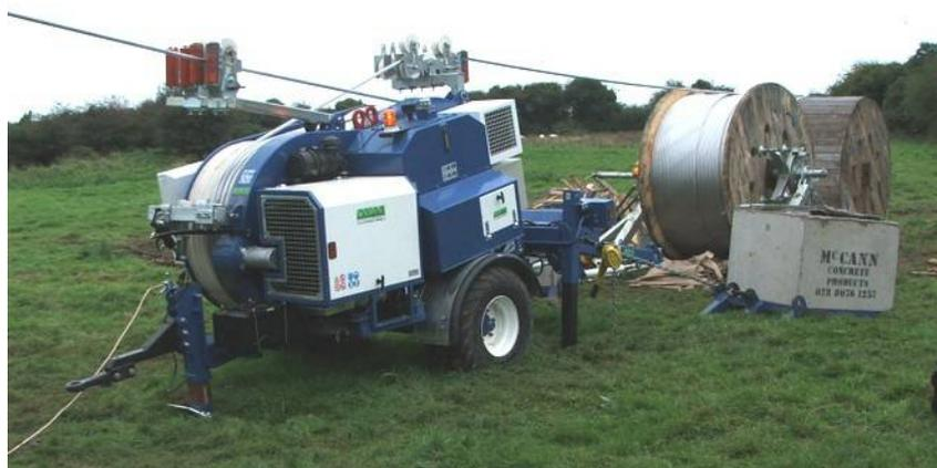
Гидравлическая натяжная-тормозная машина для протяжки одного или двух проводов. Один гидравлический контур позволяет тормозить с постоянной силой независимо от изменений в процессе тяжения. При натяжении сохраняется постоянная скорость в обоих направлениях. Устройство программирования тяжения, фиксирующее заданное значение и автоматически регулирующее скорость в соответствии с нагрузкой на линии.
