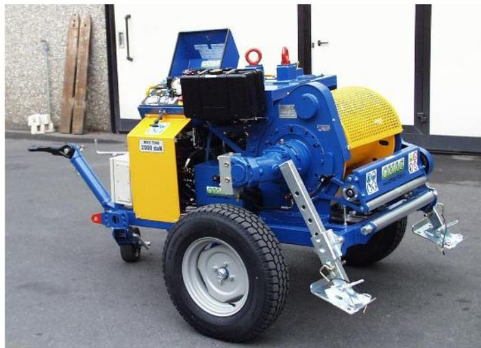
Гидравлическая лебедка предназначена для тяжения одного троса при вспомогательных операциях, а так же при монтаже и регулировках ЛЭП, и прокладках подземного кабеля. Для удобства транспортировки лебедка состоит из трех частей.
