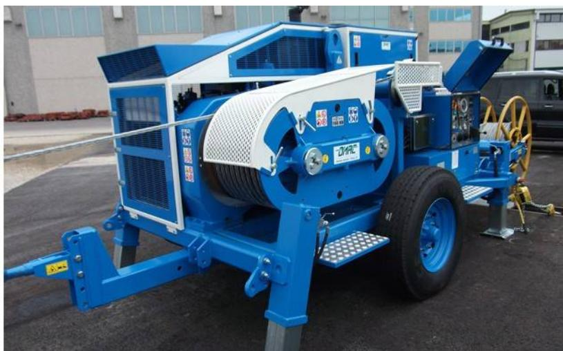
Гидравлическая натяжная машина предназначена для тяжения одного троса.
