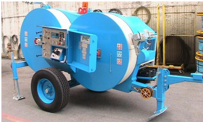
Гидравлическая тормозная машина предназначена для торможения 1 провода, либо волоконно-оптического кабеля в процессе натяжения. Один гидравлический контур позволяет непрерывно изменять силу и скорость торможения. Машина оборудована двигателем для осуществления обратного тяжения.
