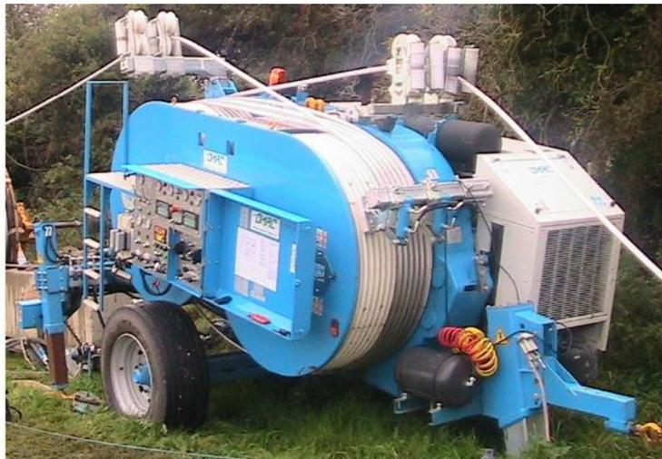
Гидравлическая натяжная-тормозная машина для протяжки одного или двух проводов.
