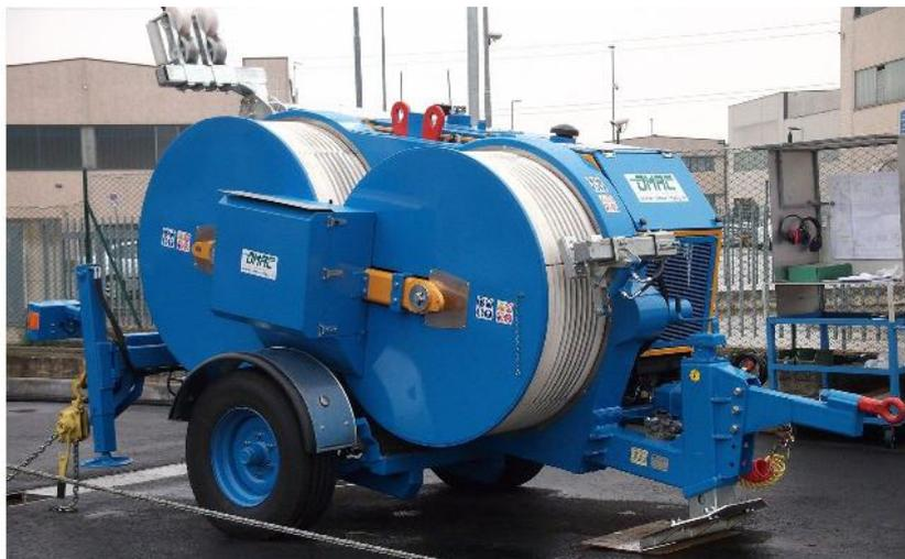
Гидравлическая тормозная машина предназначена для торможения 1 или 2 проводов, либо волоконно-оптического кабеля в процессе натяжения. Один гидравлический контур позволяет непрерывно изменять силу и скорость торможения. Машина оборудована двигателем для осуществления обратного тяжения.
