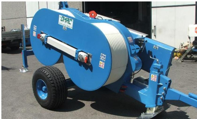
Гидравлическая тормозная машина предназначена для торможения 1 или 2 проводов, либо волоконно-оптического кабеля в процессе натяжения. Один гидравлический контур позволяет непрерывно изменять силу и скорость торможения.
