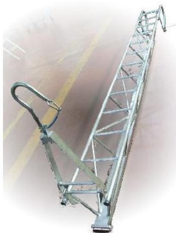
Анкерная лестница изготовлена из легкого алюминиевого сплава со ступеньками из антискользящего материала и вращающимися крюками из стали с горячей оцинковкой. Лестница поставляется в комплекте с фиксированным крюком для опор с защелкой 220мм и вращающимся крюком для крепления к проводам при использовании лестницы в горизонтальном положении. Лестница имеет трапецевидную форму.
