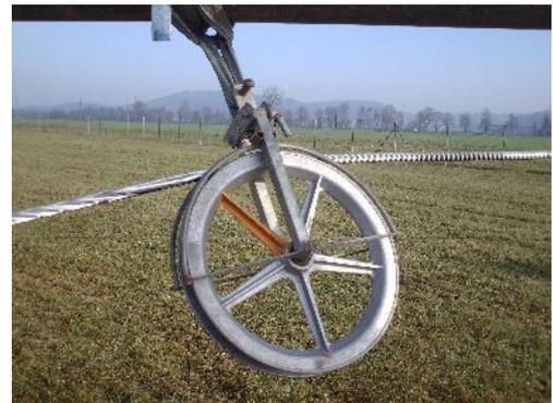
Модель **F144.100.60** Специально спроектирована для монтажа ОКГТ
