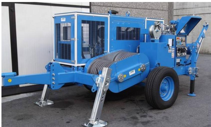
Гидравлическая натяжная машина предназначена для тяжения одного троса.
