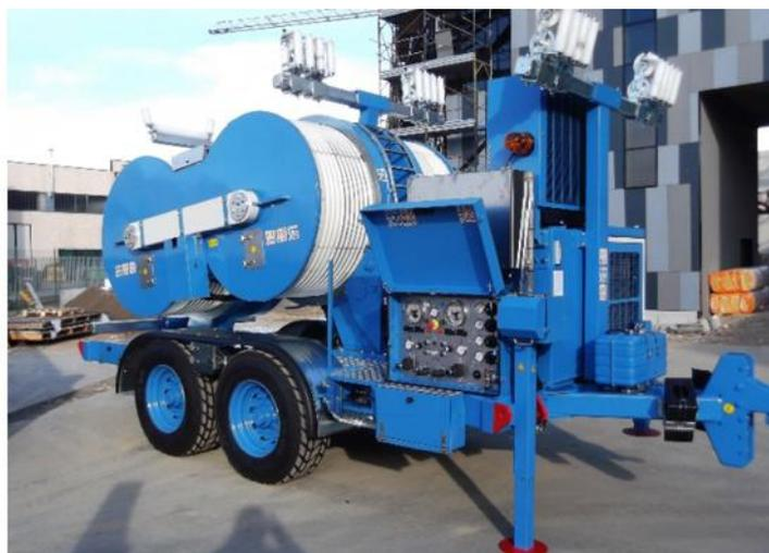
Гидравлическая тормозная машина предназначена для торможения 1, 2, 3, 4 или 6 проводов в процессе натяжения. Два гидравлических контура позволяют непрерывно изменять силу и скорость торможения. Оба контура могут использоваться как независимо друг от друга, так и совместно с автоматическим разделением силы тяжения/торможения. Машина оборудована двигателем для осуществления обратного тяжения. Один гидравлический контур может независимо от другого менять силу и скорость в обоих направлениях.
