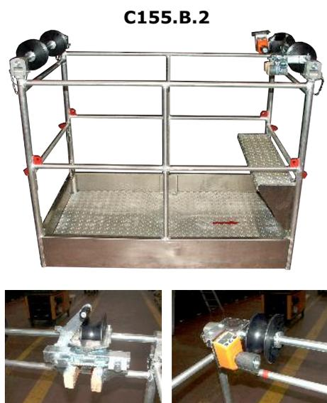
**C155.BM** **Моторизованная двухместная тележка.** Предназначена для 2-, 3- или 4х-проводной электрической линии. зготовлена из алюминиевого сплава с нейлоновыми колесами на шарикоподшипниках. Приводные колеса обтянуты полиуретаном с высоким коэффициентом сжатия. Направляющая ось с обрешиненными колесами. Стационарный тормоз и счетчик метров.
