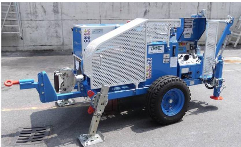
Гидравлическая натяжная машина предназначена для протяжения одного троса. Один гидравлический контур позволяет непрерывно изменять скорость в обоих направлениях работы с одним единственным устройством управления.
