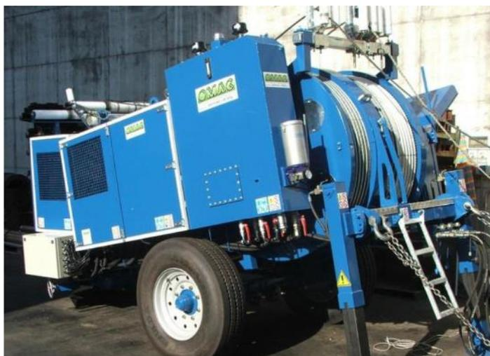
Гидравлическая тормозная машина предназначена для торможения 1, 2 или 3 проводов в процессе натяжения.
