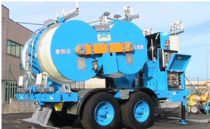
Гидравлическая тормозная машина предназначена для торможения 1, 2, 3 или 4 проводов в процессе натяжения.
