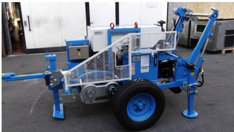
Гидравлическая натяжная машина предназначена для тязения одного троса. Один гидравлический контур позволяет непрерывно изменять скорость в обоих направлениях работы с одним единственным устройством управления.
