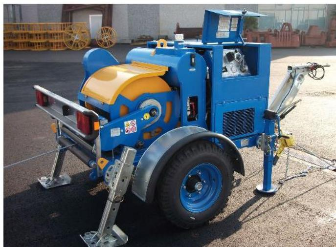
Гидравлическая лебедка предназначена для тяжения одного троса при вспомогательных операциях, а так же при монтаже и регулировках ЛЭП, и прокладках подземного кабеля. Для удобства транспортировки лебедка состоит из трех частей. Один гидравлический контур позволяет постоянно изменять скорость в обоих направлениях с помощью одной панели управления.
