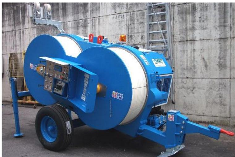
Гидравлическая тормозная машина предназначена для торможения 1 или 2 проводов, либо волоконно-оптического кабеля в процессе натяжения.
