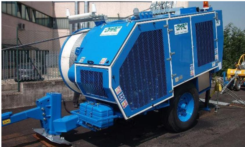
Гидравлическая натяжная-тормозная машина для протяжки 1, 2, 3 или 4 проводов. Один гидравлический контур позволяет тормозить с постоянной силой независимо от изменений в процессе тяжения. При натяжении сохраняется постоянная скорость в обоих направлениях. Устройство программирования тяжения, фиксирующее заданное значение и автоматически регулирующее скорость в соответствии с нагрузкой на линии.
