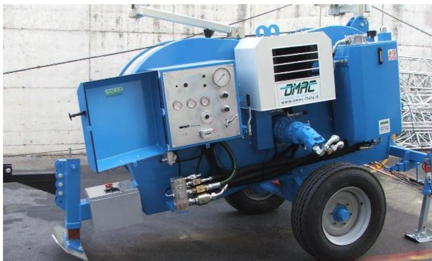
Гидравлическая тормозная машина предназначена для торможения одного провода или волоконно-оптического кабеля в процессе натяжения. Один гидравлический контур позволяет непрерывно изменять силу и скорость торможения.
