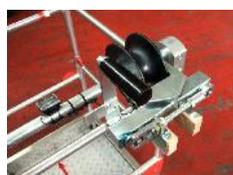
**C155.AM.2** Моторизованная тележка.
