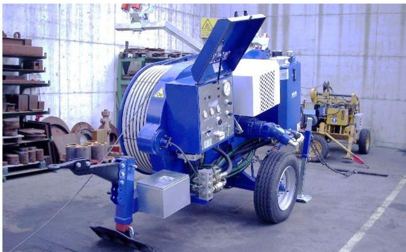
Гидравлическая тормозная машина предназначена для торможения одного провода или волоконно-оптического кабеля в процессе натяжения. Один гидравлический контур позволяет непрерывно изменять силу и скорость торможения.
