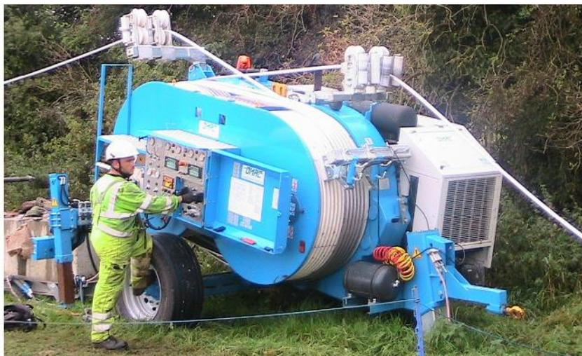
Гидравлическая тормозная машина предназначена для торможения 1 или 2 проводов в процессе натяжения. Два гидравлических контура позволяют непрерывно изменять силу и скорость торможения. Контурсы могут использоваться как независимо друг от друга, так и совместно с автоматическим разделением силы тяжения/торможения. Машина оборудована двигателем для осуществления обратного тяжения. Один гидравлический контур может независимо от другого менять силу и скорость в обоих направлениях.
