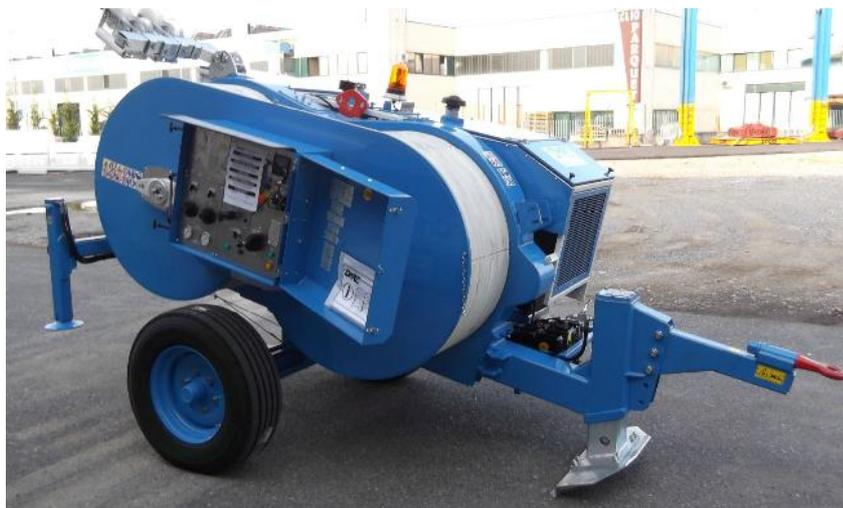
Гидравлическая натяжная-тормозная машина для протяжки одного или двух проводов. Один гидравлический контур позволяет тормозить с постоянной силой независимо от изменений в процессе тяжения. При натяжении сохраняется постоянная скорость в обоих направлениях. Устройство программирования тяжения, фиксирующее заданное значение и автоматически регулирующее скорость в соответствии с нагрузкой на линии.
