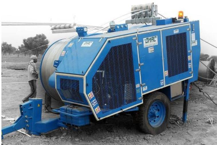
Гидравлическая тормозная машина предназначена для торможения 1, 2, 3 или 4 проводов в процессе натяжения. Один гидравлический контур позволяет непрерывно изменять силу и скорость торможения. Машина оборудована двигателем для осуществления обратного тяжения.
