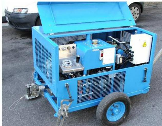
Гидравлическая натяжная машина предназначена для тяжения одного троса в траншеях и трубах. Используется для прокладки силовых кабелей и оптических кабелей и проводов. Один гидравлический контур позволяет непрерывно изменять скорость в обоих направлениях работы с одним единственным устройством управления.
