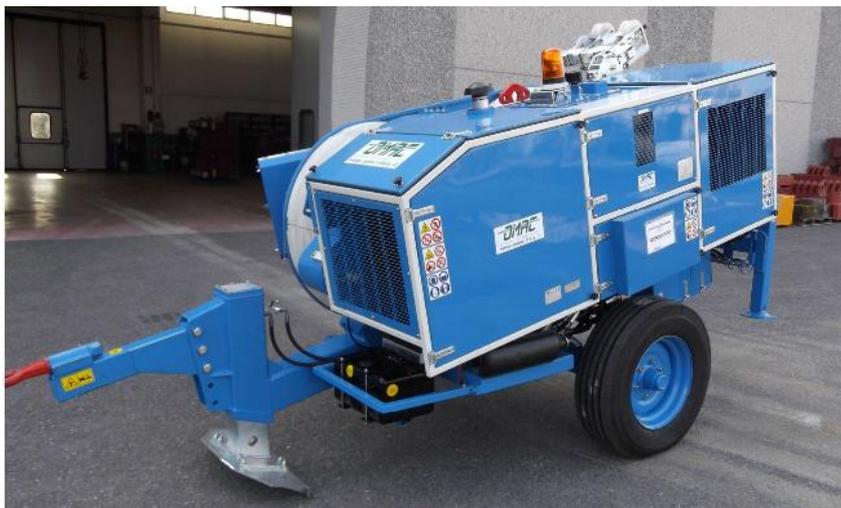
Гидравлическая тормозная машина предназначена для торможения 1 провода, либо волоконно-оптического кабеля в процессе натяжения. Один гидравлический контур позволяет непрерывно изменять силу и скорость торможения. Машина оборудована двигателем для осуществления обратного тяжения. Машина оборудована устройством программирования тяжения, фиксирующим заданное значение и регулирующим автоматически скорость в соответствии с нагрузкой на линии.
