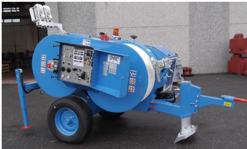
Гидравлическая тормозная машина предназначена для торможения 1 или 2 проводов, либо волоконно-оптического кабеля в процессе натяжения.
