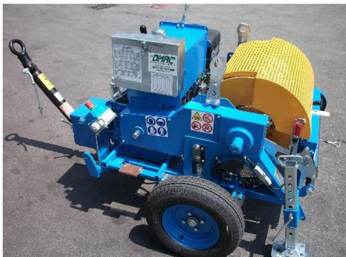
Гидравлическая лебедка предназначена для тяжения одного троса при вспомогательных операциях, а так же при монтаже и регулировке ЛЭП, и прокладке подземного кабеля. Один гидравлический контур позволяет постоянно изменять скорость в обоих направлениях с помощью одной панели управления.
