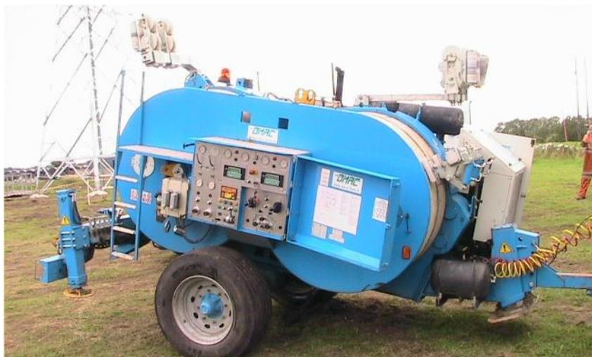
Гидравлическая тормозная машина предназначена для торможения 1 или 2 проводов в процессе натяжения. Два гидравлических контура позволяют непрерывно изменять силу и скорость торможения. Контуров могут использоваться как независимо друг от друга, так и совместно с автоматическим разделением силы тяжения/торможения. Машина оборудована двигателем для осуществления обратного тяжения. Один гидравлический контур может независимо от другого менять силу и скорость в обоих направлениях.
