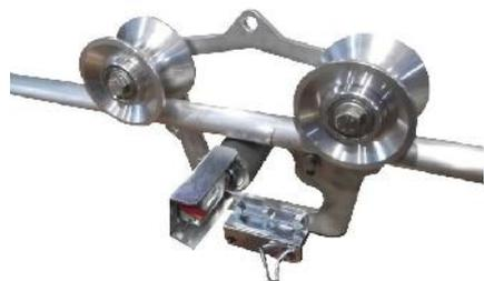
Устройство для измерения длины троса и провода. Измерительное колесо изготавливается из стали. Скользящие колеса производятся из алюминия и нейлона. Предназначено для троса диаметром до 50мм. Размеры: A x B x C = 430 x 370 x 255 мм; D = 70 мм. Вес: 5,5 кг
