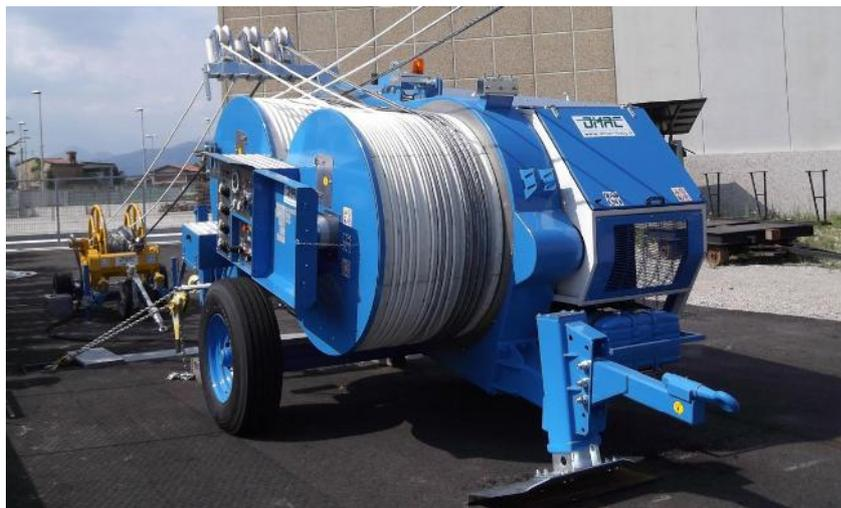
Гидравлическая тормозная машина предназначена для торможения 1, 2 или 3 проводов в процессе натяжения. Один гидравлический контур позволяет непрерывно изменять силу и скорость торможения. Машина оборудована двигателем для осуществления обратного тяжения.
