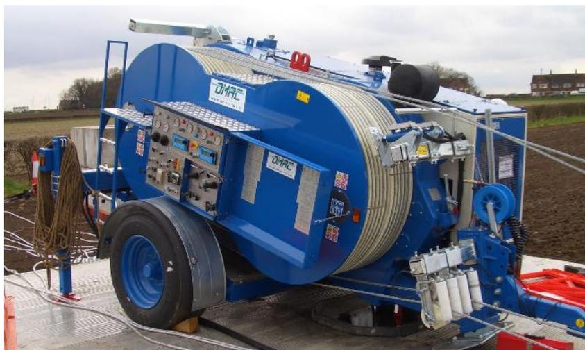
Гидравлическая натяжная-тормозная машина для протяжки одного или двух проводов.
