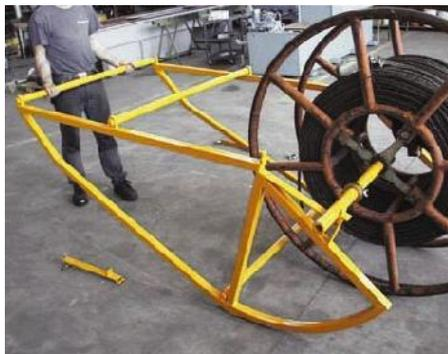
**F157** Подставка под барабаны предназначена для поднятия и разматывания барабанов с проводом. Подставка разборная, что упрощает ее перемещение. Снабжена барабанной осью.
