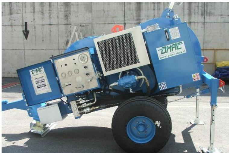
Гидравлическая тормозная машина предназначена для торможения 1 или 2 проводов, либо волоконно-оптического кабеля в процессе натяжения. Один гидравлический контур позволяет непрерывно изменять силу и скорость торможения.
