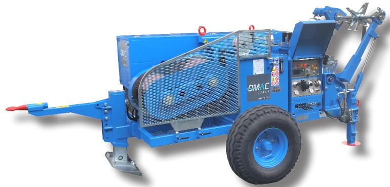
**Hydraulische Freileitungs-Winde zum Ziehen eines Seiles während des Einzugs von Freileitungen. Ein Hydraulikkreis ermöglicht die kontinuierliche Geschwindigkeitsänderung in beiden Drehrichtungen. Die Winde wird über ein Bedienfeld getsteuert.**
