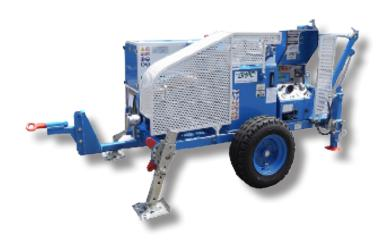
Hydraulische Freileitungs-Winde zum Ziehen eines Seiles während des Einzugs von Freilichtwellenleitern. Ein Hydraulikkreis ermöglicht die kontinuierliche Geschwindigkeitsregulierung in beiden Drehichtungen, gesteuert wird die Winde über ein Bedienfeld.
