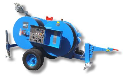
Hydraulische Winde-Bremse für den Einzug 1er, oder 2er Leitungsbündel bestimmt. Ein Hydraulikkreis ermöglicht das Spannen mit konstanter Kraft auch bei Änderung der Zuggeschwindigkeit. Die Maschine ist mit einem System ausgestattet ,welches das Halten einer automatisch vorgegebenen Zugkraft ermöglicht, indem es die Geschwindigkeit an die Last anpasst (auch bei Nullgeschwindigkeit).
