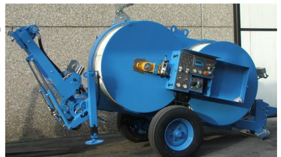
014 - Trommelpulgerät mit der Möglichkeit Trommeln bis 1400 mm Durchmesser auf einem Arm zu montieren
